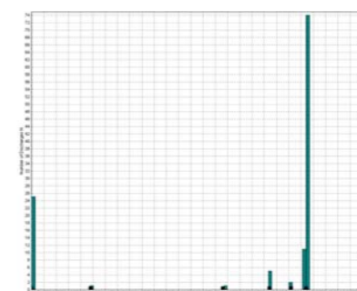
Roncslásmentes vizsgálat: nincs átütés; az RK hisztogram alapján a kötés ellenőrizhető és szükség esetén újra szerelhető
